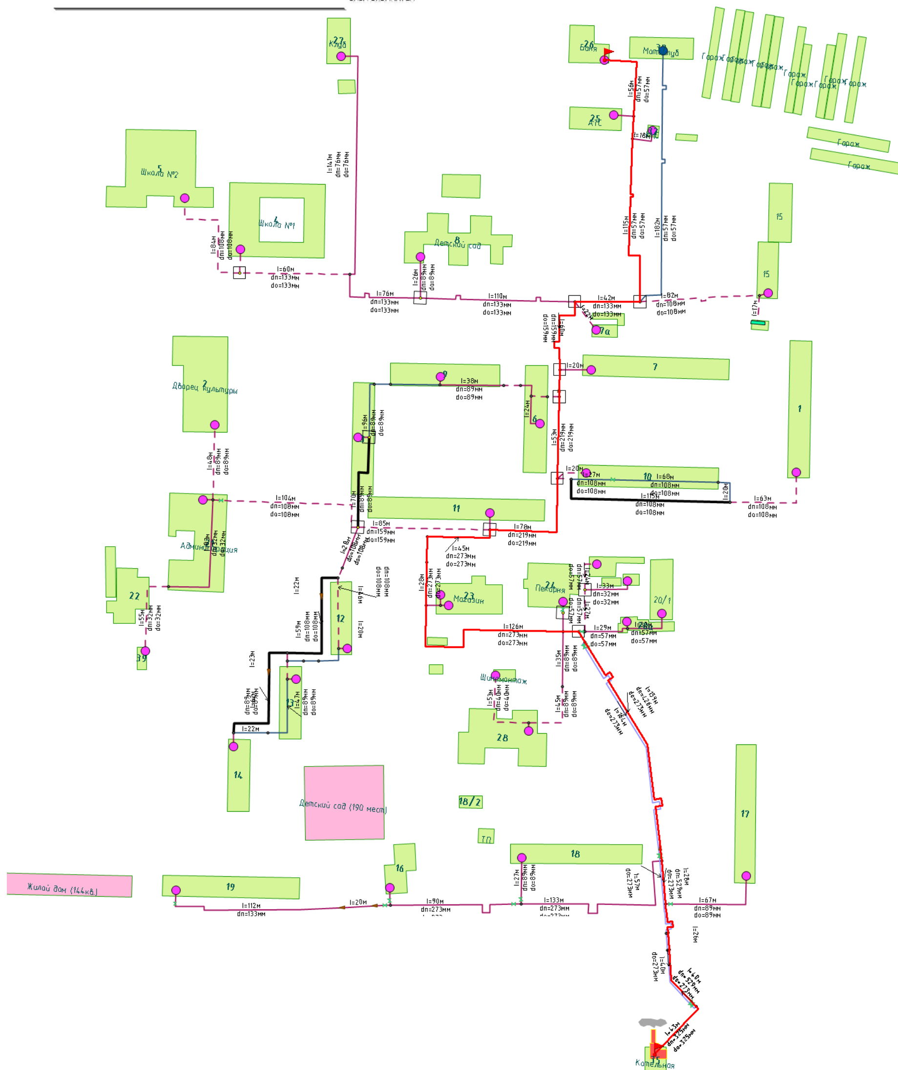
Рисунок 15 – Путь построения пьезометрического графика до определяющего потребителя – Баня пос. Ростовка, 26
